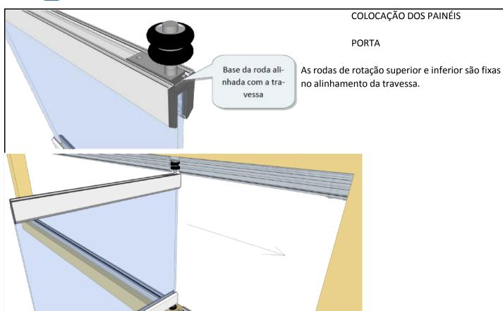
Inserem-se as rodas nos orifícios das calhas e corre-se o painel até à extremidade. Se for neces-sário, ajustam-se as calhas, recorrendo a calços.
