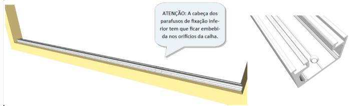
A calha inferior deve ser nivelada pelo ponto mais alto. O nivelamento da calha inferior é fundamental damental para o correcto funcionamento do sistema.
